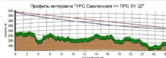
Рис.2 К анализу отражений на интервале "УРС Смоленская - ПРС КУ 22"
