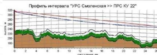
Рис.2 К анализу отражений на интервале "УРС Смоленская - ПРС КУ 22"
