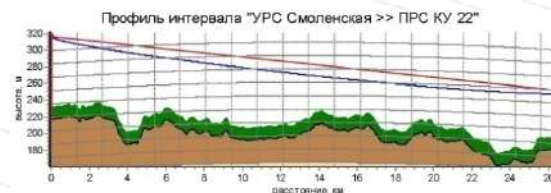
Рис.1 Профиль интервала "УРС Смоленская - ПРС КУ 22"
